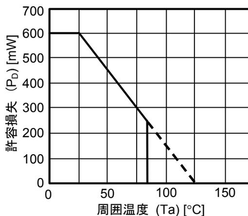
図3 パッケージ許容損失 (基板実装時)
