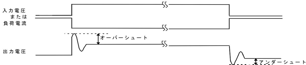
1.1 電源投入時 S-817A30A ( $C_L=1\ \mu\text{F}$ はセラミックコンデンサを使用)
