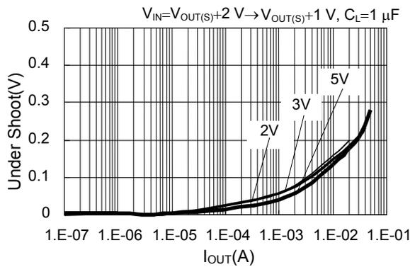
電源変動時アンダーシュートの $V_{DD}$ 依存性
