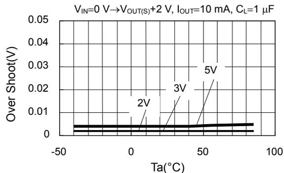
1.2 電源投入時 S-817B30A ( $C_L=1\ \mu\text{F}$ はセラミックコンデンサを使用)
