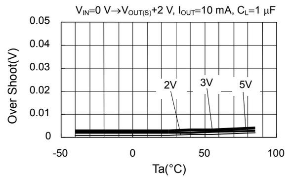
1.3 電源変動時 S-817A30A/S-817B30A ( $C_L=1\ \mu\text{F}$ はセラミックコンデンサを使用)
