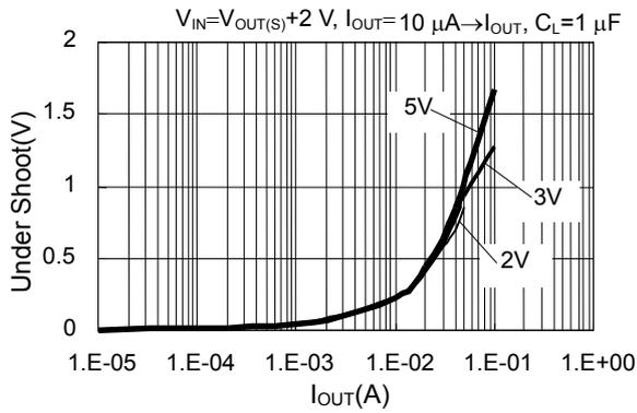
負荷変動時アンダーシュートの $V_{DD}$ 依存性
