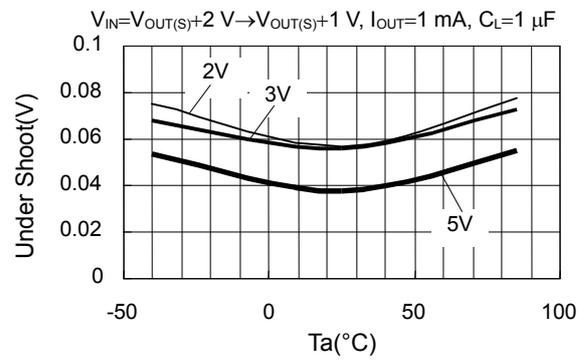
1.4 負荷変動時 S-817A30A/S-817B30A ( $C_L=1\ \mu\text{F}$ はセラミックコンデンサを使用)
