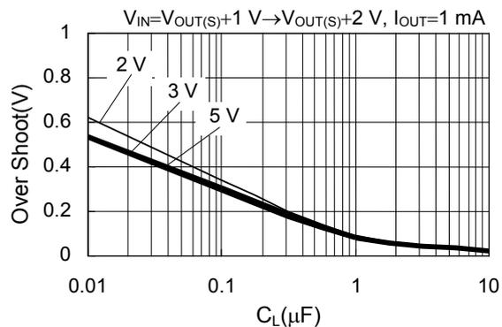
電源変動時オーバーシュートの $V_{DD}$ 依存性
