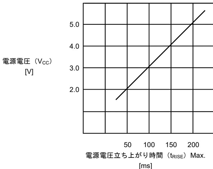
例) 使用電源電圧が5.0 Vの場合 : 5.0 Vまでの到達時間は200 ms以内にしてください。
