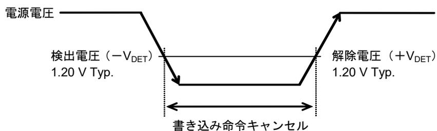
図20 低電源電圧時の動作
