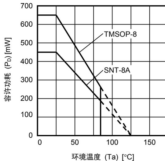
图 4 封装容许功耗 (基板安装时)
